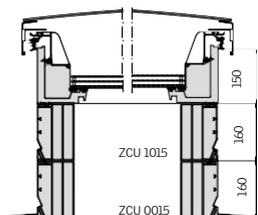
Flachdach-Fenster CVU/CFU mit Aufsetzkranzen ZCU 0015 und ZCU 1015
