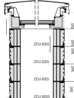
Flachdach-Fenster CVU/CFU mit Aufsetzkranz-Set ZCU S000, bestehend aus Aufsetzkranzen ZCU 0015 und ZCU 1015 + zusätzliche Aufsetzkranz-Adapter ZCU 1015. Es können bis zu drei Aufsetzkranz-Adaptern ZCU 1015 gestapelt werden.
