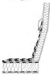
Podstawa GFK-RAK do oddymiania opcjonalnie z kołnierzem z żywicy poliestrowej GFK
