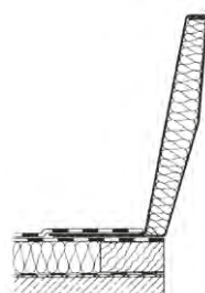
Podstawa stalowo-aluminiowa z funkcją oddymiania, typ RAK, o wys. 30 cm
