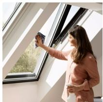
Pour nettoyer la surface vitrée extérieure de l'intérieur, faites pivoter l'ouvrant et fixez-le en position de nettoyage à l'aide des loqueteaux latéraux. Il est possible de nettoyer l'extérieur de l'ouvrant fixe en ouvrant l'ouvrant gauche (vu de l'intérieur).
