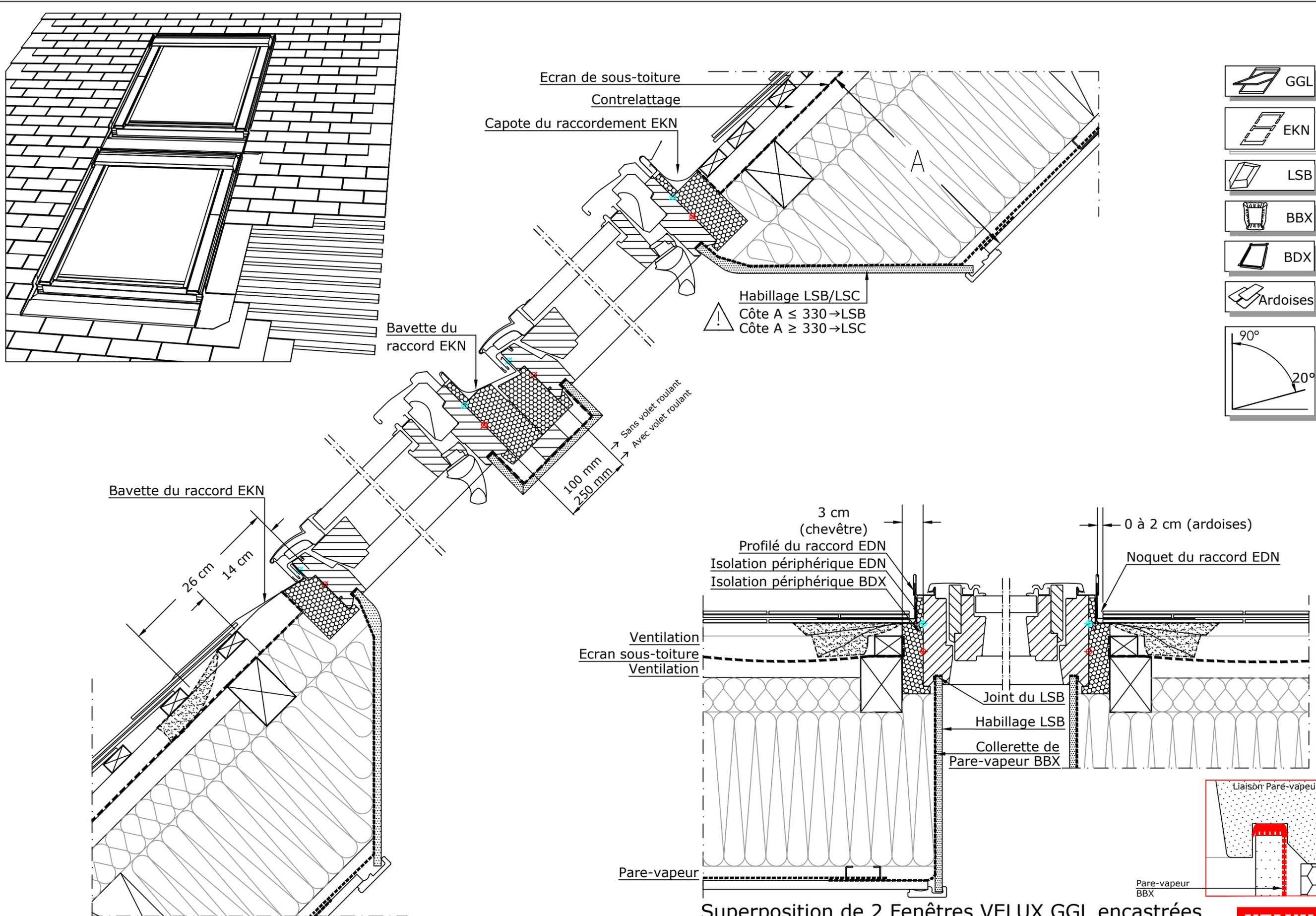
**Superposition de 2 Fenêtres VELUX GGL encastrées sur ardoises avec raccord EKN**
