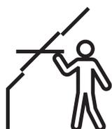
Les fenêtres à ouverture par rotation, à commande manuelle vers le haut, permettent de placer les meubles directement sous la fenêtre sans gêner le fonctionnement de celle-ci. Nous recommandons une hauteur de montage permettant une ligne de vue dégagée vers l'extérieur, à la fois en position debout et assise. Veuillez noter que la hauteur optimale de la fenêtre dépend de l'inclinaison du toit.
