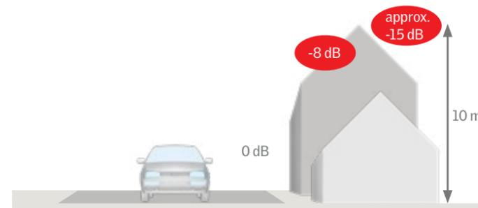
Vergleich zwischen einem Fassadenfenster und einem Oberlicht. Bei Ausrichtung zur Straße ergibt sich am Einbauort eines Oberlichts ein 8 dB niedrigerer Schallpegel als bei einem Fassadenfenster. Befindet sich der Einbauort des Oberlichts näher zum Hinterhof, ergibt sich ein noch geringerer Schallpegel (ca. 15 dB).
