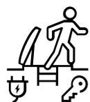
Das neue Flachdach-Fenster CXU bietet einen einfachen und sicheren Zugang zum Dach für eventuelle Reparaturen oder Wartungsarbeiten. Die Ausstiegsfunktion wird per mitgeliefertem Schlüsselschalter aktiviert. Für den Betrieb ist zusätzlich eine Steuereinheit erforderlich.
