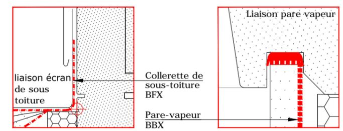
**Fenêtre VELUX GGL sur petites tuiles plates avec raccord EDP**
