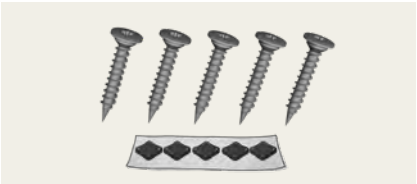
ZOZ 262K Schrauben-Set (5x 30mm) inkl. Butyl für Außenrollläden SSL -K bzw. SML -K Für die Montage von SSL -K/SML -K bei Austausch eines alten Außenrollladens zum Ausgleich der unterschiedlichen Schraubenlänge
