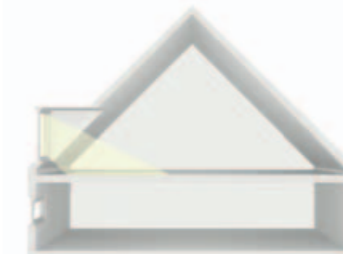
Homlokzati ablak beépítése a tetőszerkezetbe kb. 3-szor annyiba kerül.
