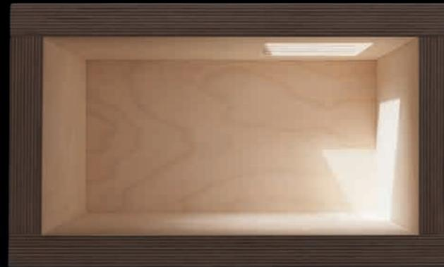
Über eine horizontale Öffnung im Dach werden zentrale oder tiefe Raumbereiche intensiv mit Tageslicht versorgt.
