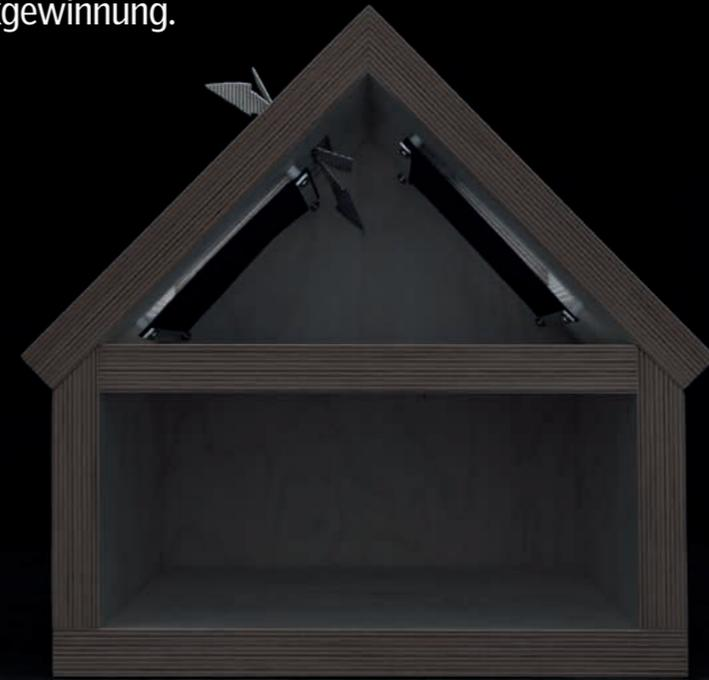
Eine kontinuierliche Lüftung im Hintergrund ist im Winter wegen des Wärmeverlusts gegebenenfalls nicht durchführbar. Mit der VELUX Smart Ventilation Einheit werden mindestens 75% der Energie durch Wärmerückgewinnung aufgefangen. Die dezentrale Einheit kann z. B. ideal im Schlafzimmer eingesetzt werden. **Produktempfehlungen: VELUX Smart Ventilation, VELUX Rollläden. Siehe S. 112 und 115.**
