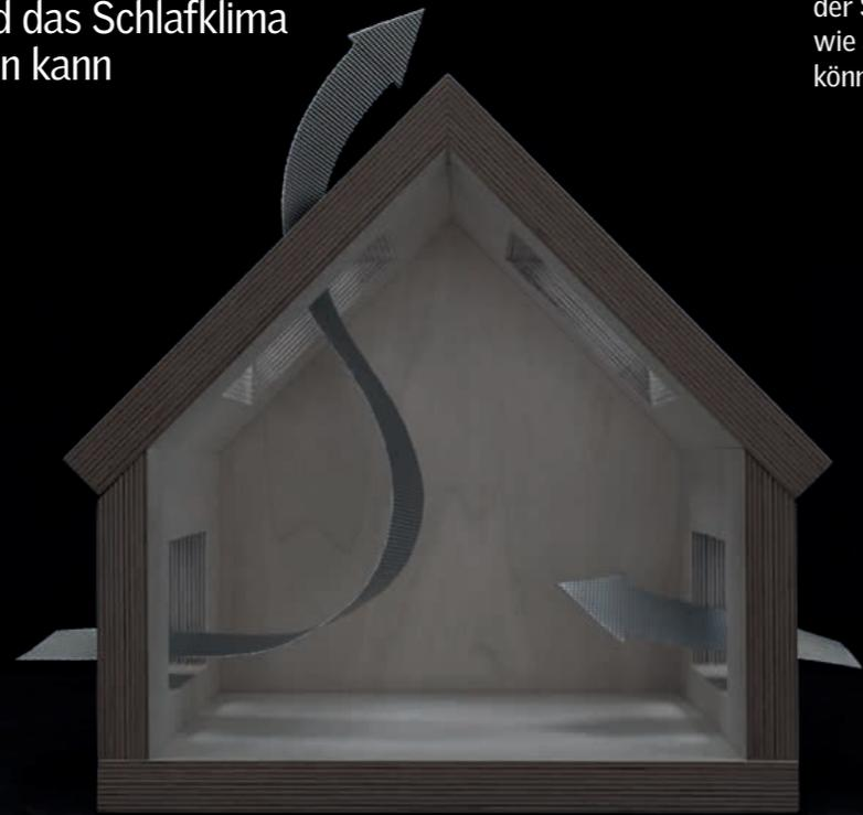
Bei der nächtlichen Kühlung wird die thermische Masse eines Gebäudes mit kalter Außenluft abgekühlt (Lüftungskühlung). Dadurch wird eine technische Kühlung obsolet. **Produktempfehlungen: VELUX ACTIVE mit NETATMO, VELUX INTEGRA® Dachfenster mit Schallschutzverglasung, VELUX Rollläden. Siehe S. 112.**
