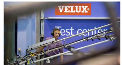
Die Schlagregendichtheit von Installation und Modul wird in einem Windkanal mit Windgeschwindigkeiten bis zu 37 m/s (Hurrikane) getestet. Getestet wird eine vollständige Installation mit Modulen und Eindeckrahmen.
