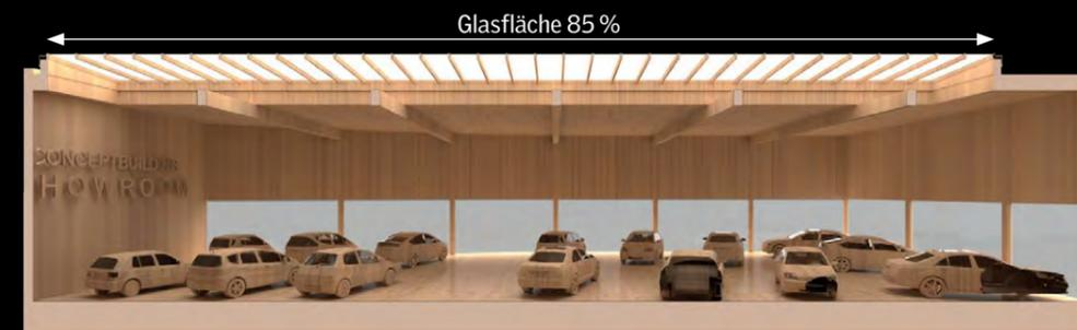
Durch den Einsatz von Oberlichtern werden nur 85 % der Glasfläche im Vergleich zum Einsatz von Fassadenfenstern (100 %) benötigt.
