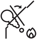
Ein VELUX Rauchabzugsfenster ist so konzipiert, dass Rauch und überschüssige Hitze schnell abgeleitet werden. Das Fenster wird mit einem Rauchabzugsmotor geliefert und erfüllt alle EU-Anforderungen. Für den Betrieb und die automatische Öffnung kann eine handelsübliche Brandrauchsteuerung kombiniert werden. Für nähere Informationen kontaktieren Sie bitte Velux Österreich.
