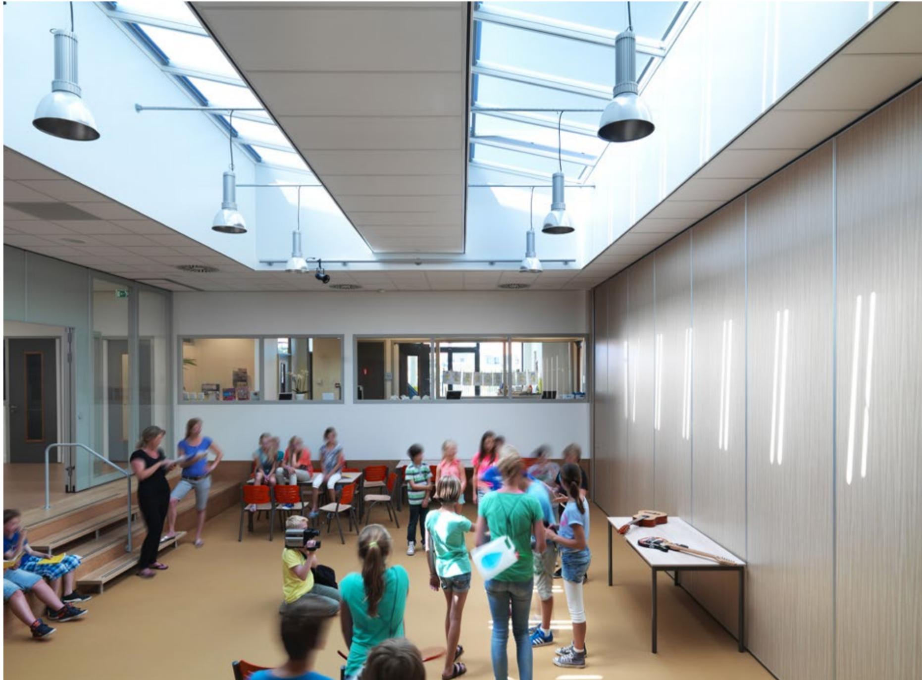
Das zentrale Atrium erhält den größten Teil seines Lichts von den großflächigen VELUX Modular Skylights, die auch für Frischluft und einen dynamischen, lebendigen Tageslichtverlauf sorgen. Die direkt unter den Modulen angebrachte elektrische Beleuchtung gewährleistet auch abends und an dunklen Wintertagen ein angemessenes Lichtniveau.
