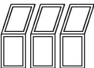
Für VELUX DACHTERRASSEN, bestehend aus einer Einheit (bestehend aus GEL und VEA-, VEB- oder VEC Elemente in Einzelkombination). Für mehrere nebeneinander eingebaute Elemente mit 10 cm Blendrahmen-Abstand können einzelne Innenfutter für Dachbalkon verwendet werden.
