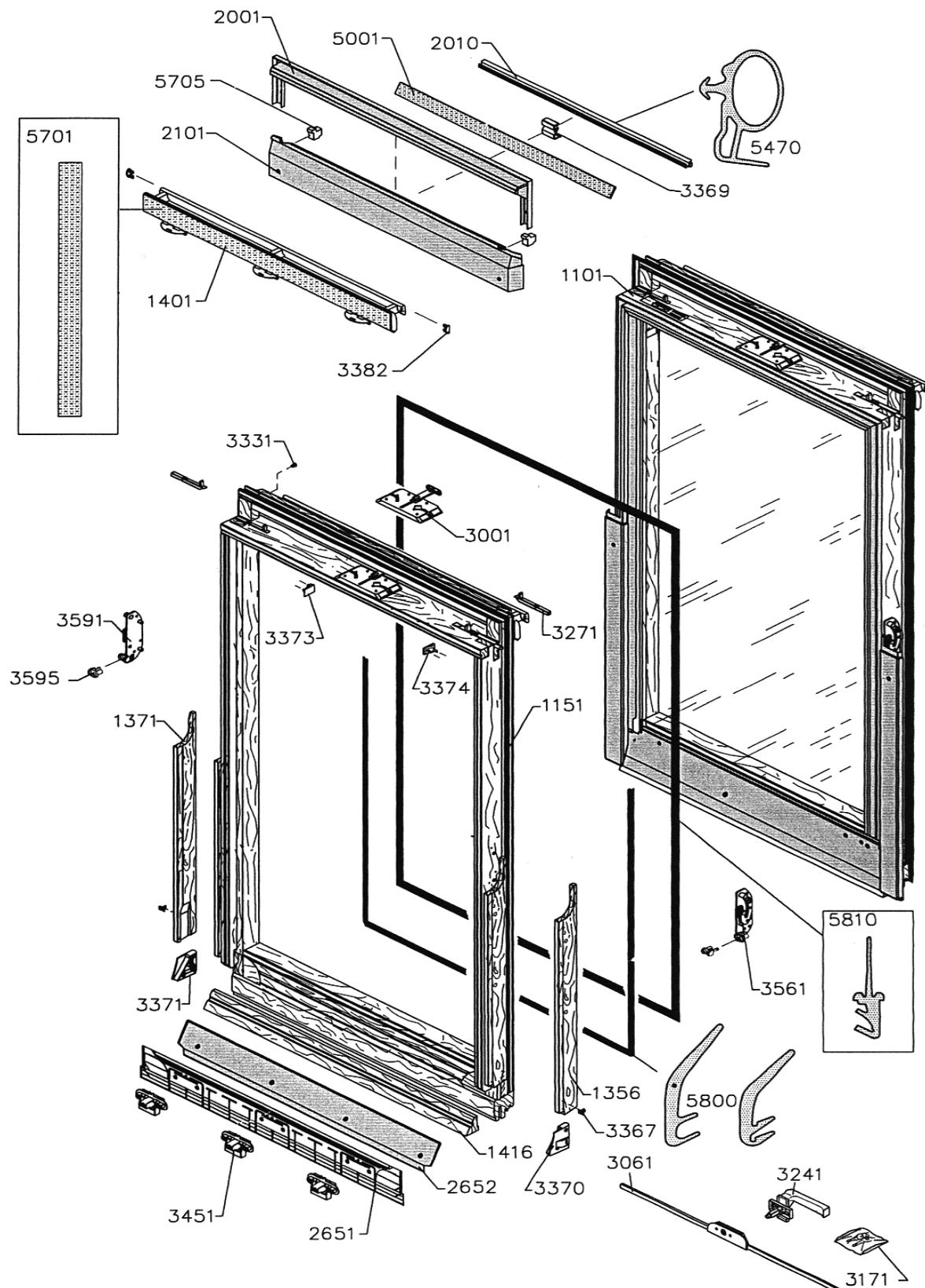
**Packstück 1 (Obenelement): Verglasung, Verglasungsdichtungen, Abdeckbleche, Kleinteile**
