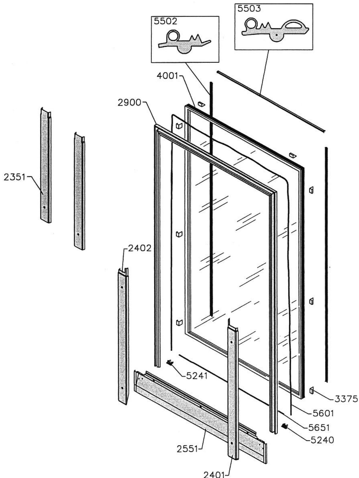
**Packstück 1 (Obenelement): Zwischenrahmen, Federstangen, Federabdeckung, Dichtungen, Kleinteile**
