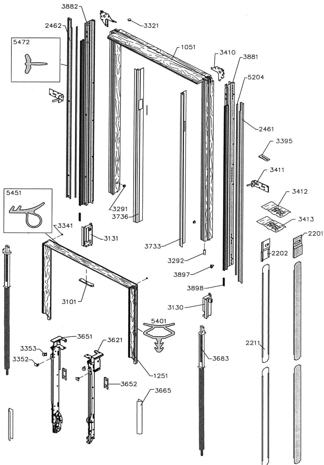
Packstück 2 (Untenelement): Flügel, Blendrahmen, Abdeckbleche, Dichtungen, Kleinteile (Grafik im Querformat)
