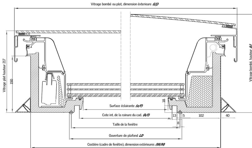
\* Pour les dimensions rectangulaires, le moteur et l'ouverture de trouvent sur le côté *long*.
