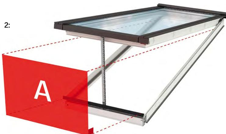
Öffnungsfläche von Rauch- und Wärmeabzugsanlagen:
