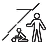
L'elemento inclinato in alto è fisso (non può essere aperto) ed è installato direttamente sotto una finestra per tetti VELUX. Nelle strutture dove il tetto è inclinato fino al pavimento, puoi estendere una finestra per tetti con un elemento inclinato in alto per ottenere più luce naturale e una vista migliore sia quando sei in piedi che da seduto.
