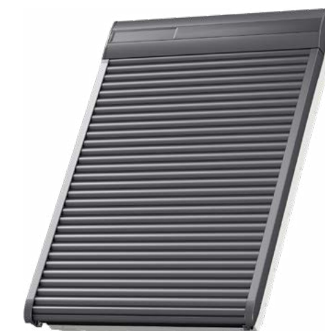
Rolete exterioare blochează radiațiile solare și nu lasă căldura verii să intre în interior, iar iarna măresc izolarea termică a ferestrelor.
