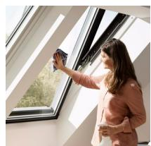
Pour nettoyer la surface vitrée extérieure de l'intérieur, faites pivoter manuellement le châssis et fixez-le en position de nettoyage à l'aide des loqueteaux latéraux.
