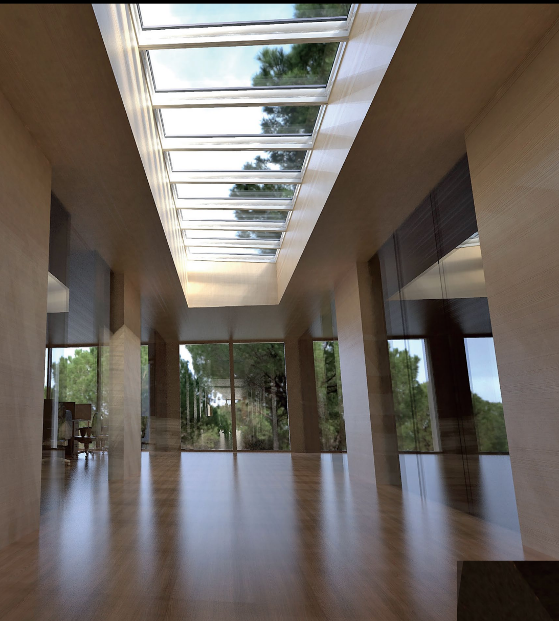
Flur mit Oberlichtern. Ein typisches Beispiel dafür, wie Gänge erhellt werden können und der Blick in den Außenraum ermöglicht wird.
